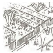
**Energie** | Die Gebäude sollten nach neuestem Energiestandart errichtet werden. Sämtliche Dächer erhalten eine PV-Anlage. Im Zentralbau entsteht ein mit nachwachsenden Rohstoffen betriebenes BHKW für die gemeinschaftliche Versorgung der Wohnungen wie der E-Mobility.
