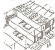
Sämtlich Dächer sind intensiv begrünt und mit übersteter PV-Anlage ausgestattet. Durch die kompakte Stellung und die vorgeschlagenen Typen können günstige A/V Verhältnisse im nachfolgenden Hochbau erreicht
