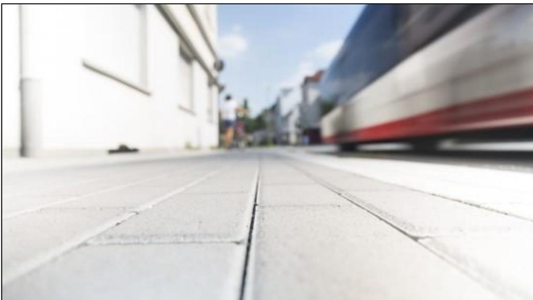
Abbildung 18: Photokatalytisch wirkende Pflastersteine (Quelle: STEAG Power Minerals GmbH)
