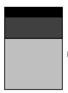
4 cm Asphaltdeckschicht
